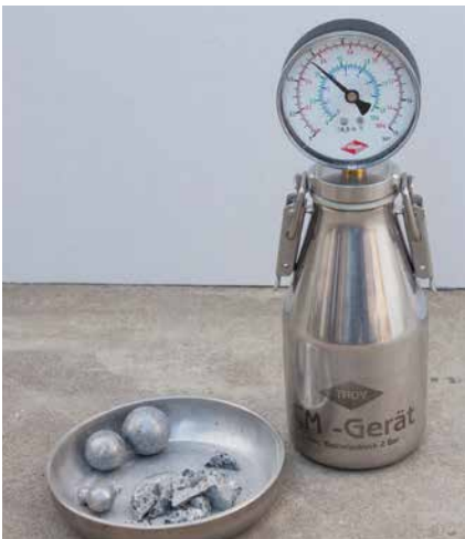
Bestimmung der Restfeuchte mit der CM-Messung
