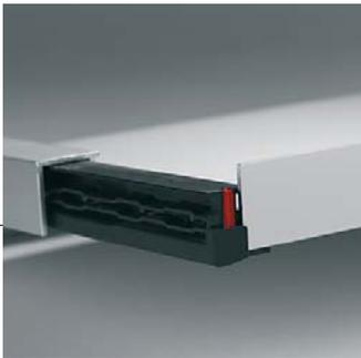
Basis für das »TwoSafe« Fensterbanksystem ist das neu konzipierte, zweiteilige TS-Gleitendstück 3800 für den seitlichen Abschluss. Dies besteht aus einem Grundprofil mit integrierter EPDM-Dichtung und dem aufgeschobenem Aluminiumprofil. Im Vergleich zu bisher marktüblichen, entkoppelten Lösungen überzeugt das TS-Gleitendstück 3800 durch die einheitliche Farb- und Materialgebung. Unschöne, optisch häufig als störend empfundene schwarze »Gummi«-Dichtungen, gehören der Vergangenheit an.
