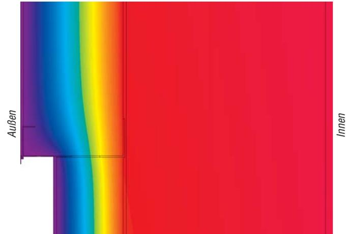
»Ungestörte« Temperaturverteilung mit WDVS Sockelabschlussprofil 3815
