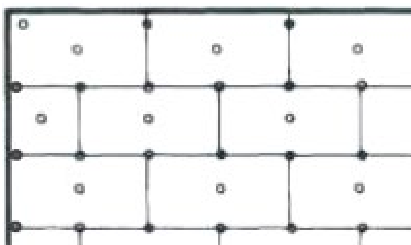
Montageschema 1: Befestigung in der Plattenmitte und an den T-Stößen
