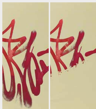
Mit Antigraffiti-Pulver PU: Das optische Erscheinungsbild der gereinigten Oberfläche ist so gut wie unverändert.
