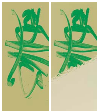
Beschichtungsmaterial ohne permanente Antigraffiti-Wirkung: Nach der Reinigung verändert sich das optische Erscheinungsbild.
