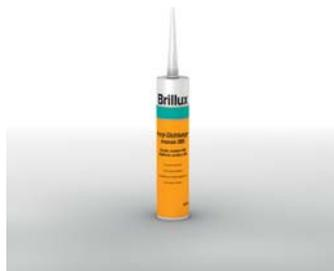
Fugendichtungsmasse auf Acrylat-Dispersionbasis zur Versiegelung von Fugen und Anschlüssen mit geringer Dehnungsbeanspruchung und keiner ständigen Feuchtigkeitsbelastung.
