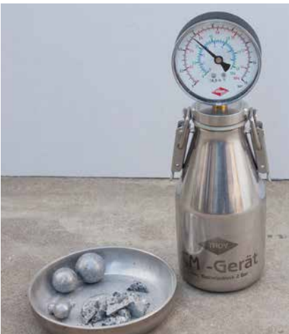
Bestimmung der Restfeuchte mit der CM-Messung
