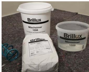
Den KlimAir Klebespachtel 1868 im angegebenen Mischungsverhältnis unter ständigem Rühren dem Zugabewasser zugeben und zu einer pastösen, homogenen und klumpenfreien Masse anrühren.
