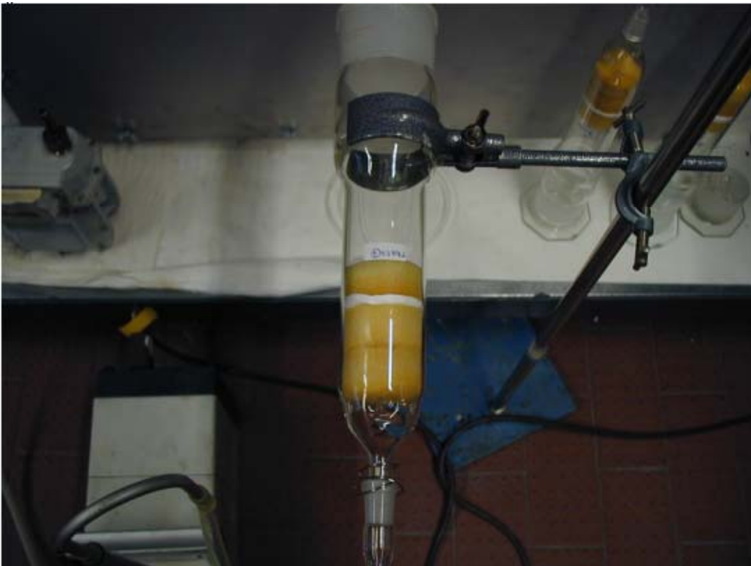
Bild 2: Bsp. einer aktiven Beprobung der Kammerluft mit PU-Schaum-Filter
