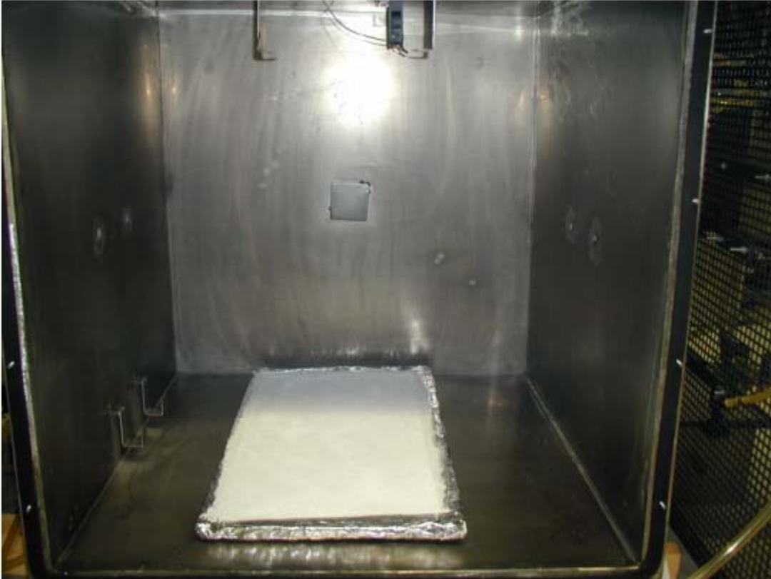
Bild 1: Blick in die 0,5 m 3 große Prüfkammer mit beschichtetem Prüfkörper
