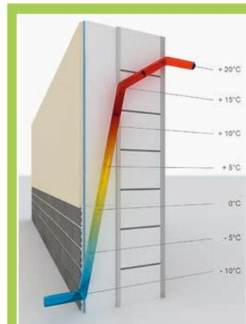
Der Temperaturverlauf in einer außen gedämmten Kalksandsteinwand zeigt die Vorteile eines WDV-Systems: Kälte und Hitze gelangen nicht bis zum Mauerwerk, höhere Temperaturen im Wandquerschnitt verhindern Tauwasserbildung.
