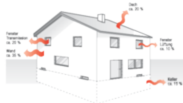
Durchschnittlicher Wärmeverlust an einem Einfamilienhaus
